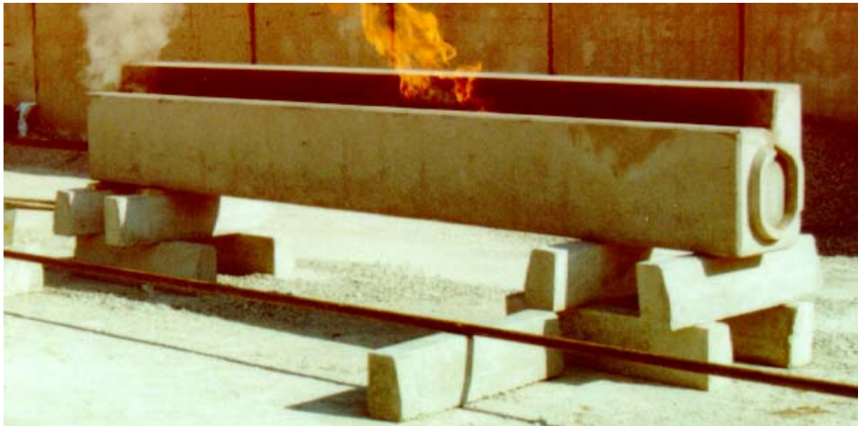
Obr.3 Horenie v štrbine odvodňovacieho žľabu
