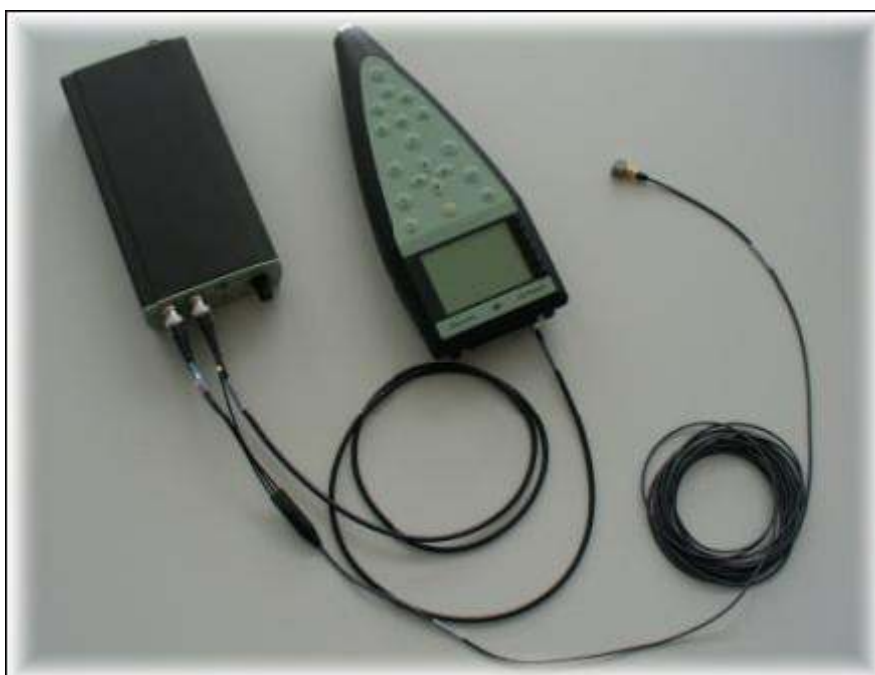
Foto č. 2: Měřicí sestava: accelerometr 4524, 2260 Observer TM a Front-end 1700
