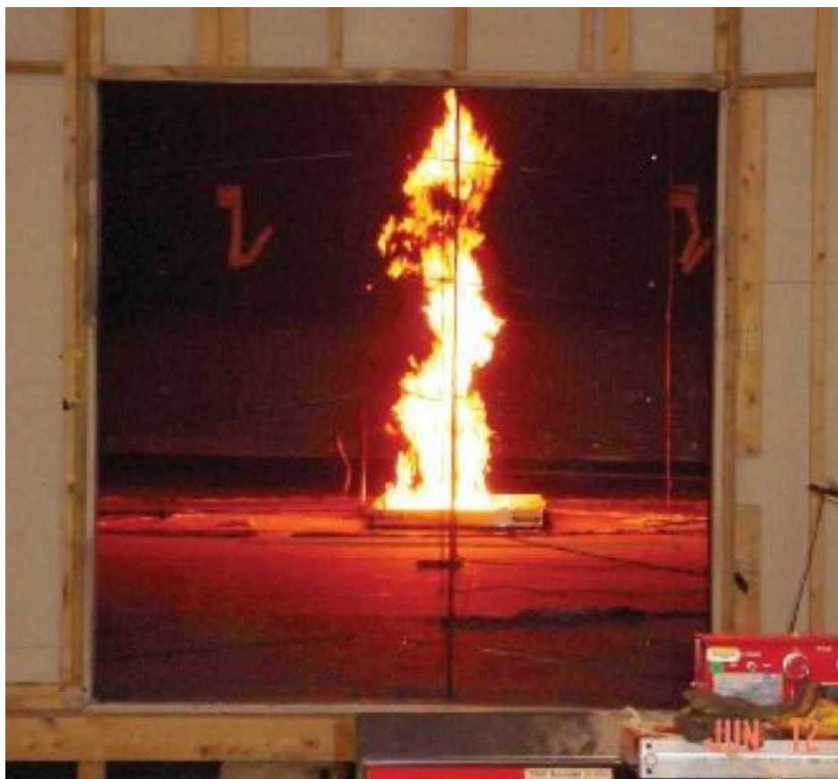
Obr. 3: Velkorozměrová požární zkouška provedená NIST v rámci projektu zaměřeného na validaci modelu požáru [3]
