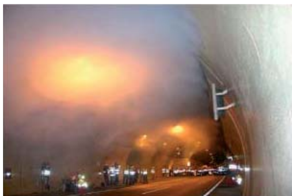
Obrázek 1: Vizualizace požárního větrání horkým kouřem pomocí aerosolu (foto Ing. Petr Bebčák, Ph.D.)
