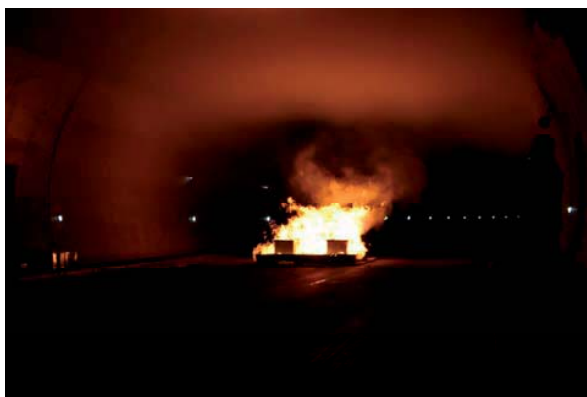
Obrázek 2: Iniciaci ethanolu v ocelových vanách a následný simulovaný požár (foto Ing. Petr Bebčák, Ph.D.)
