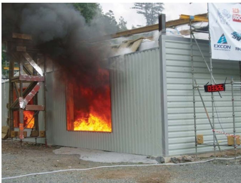
Obrázek 8: zplodiny hoření unikají oknem v čase 33:26
