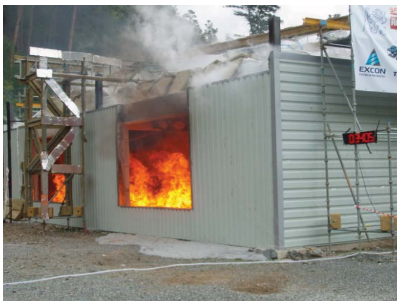
Obrázek 9: zplodiny hoření neunikají tolik oknem - došlo k prohnutí nosníků a zplodiny unikají střechou v čase 34:05
