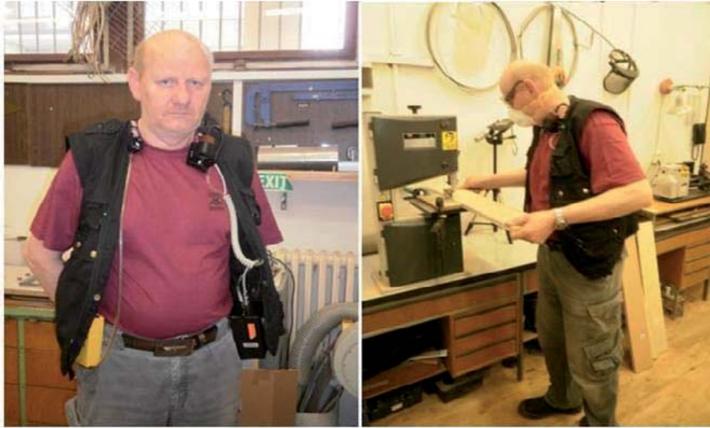
Obrázek 4: Umístění odběrových hlavic a činnost na pásové pile [4]
