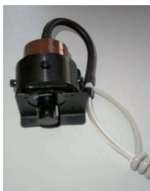
Obrázek 3: Zobrazení použitých odběrových hlavice pro frakci vdechovatelnou, thorakální a respirabilní [4]
